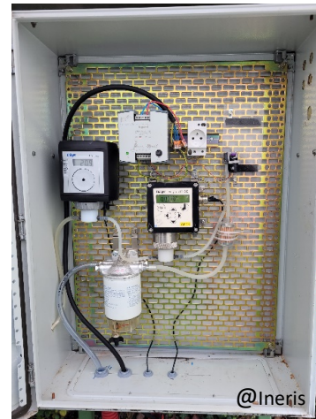
Figures 30 : Zone de prélèvement du gaz et radar distancemètre à gauche ; capteurs de gaz installés dans une centrale d'acquisition en surface à droite
