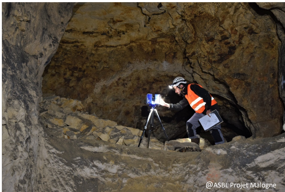
Figure 2 : Utilisation d'un scanner laser 3D pour une opération-test de surveillance dans la carrière souterraine de la Malogne (Belgique)
