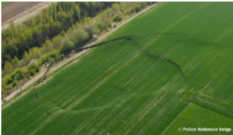
Figure 10 : Effondrement généralisé au droit de la carrière souterraine de la Malogne (Mons, Belgique)
