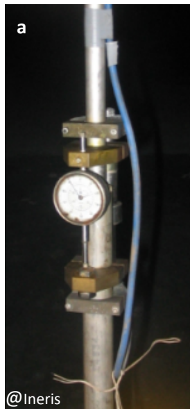
Figures 16 : Exemples de capteurs de déplacement utilisés dans le cadre de la surveillance de cavités a) canne de convergence avec comparateur ; b) fissuromètre ; c) extensomètre en forage
