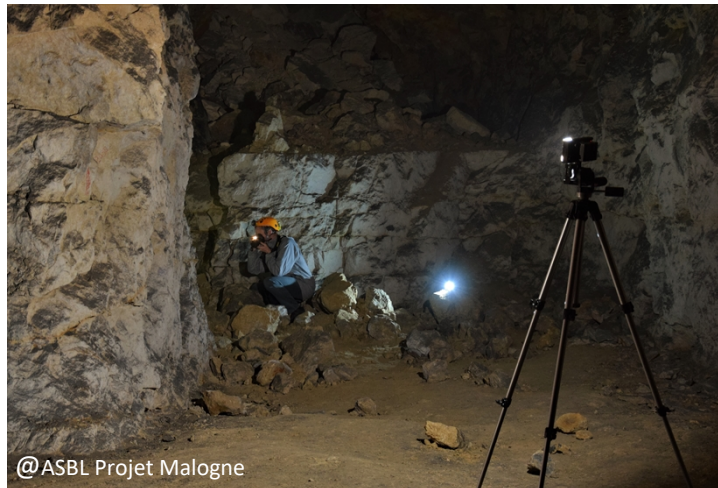
Figure 14 : Suivi par photogrammétrie dans la carrière de la Malogne
