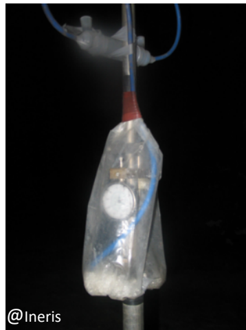
Figure 20 : Capteur électrique doublé par un comparateur
