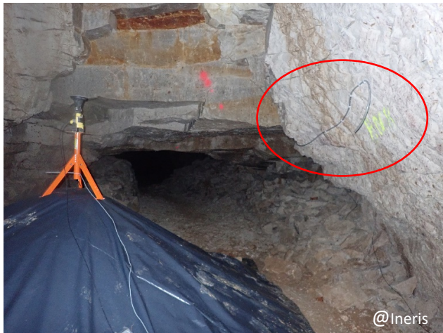
Figures 30 : Zone de prélèvement du gaz et radar distancemètre à gauche ; capteurs de gaz installés dans une centrale d'acquisition en surface à droite
