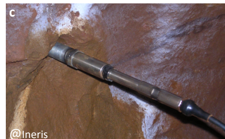
Figures 16 : Exemples de capteurs de déplacement utilisés dans le cadre de la surveillance de cavités a) canne de convergence avec comparateur ; b) fissuromètre ; c) extensomètre en forage
