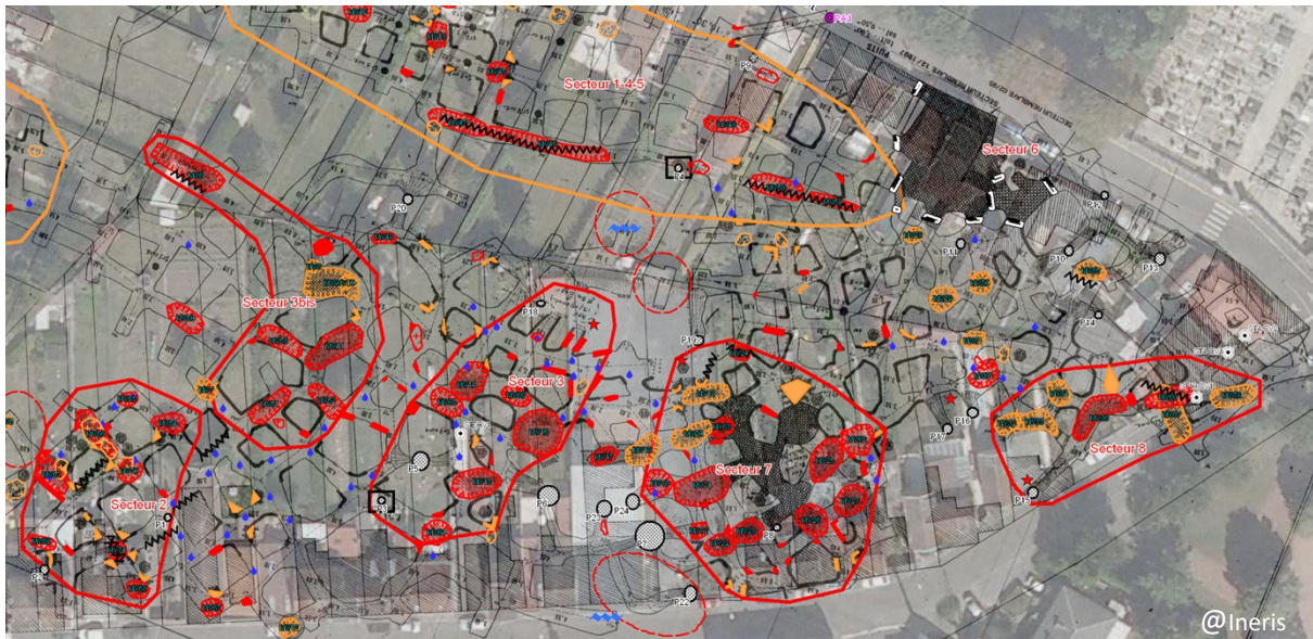
Figure 21 : Extrait d'une carte de levés géotechniques dans une carrière souterraine (figurés rouge et orange : montées de voûte ou piliers fracturés, en bleu : venues d'eau...)
