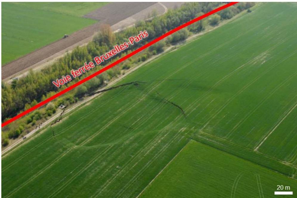
Figure 28 : Vue aérienne montrant les effets en surface de l'effondrement généralisé survenu en 2015 aux carrières de la Malogne (modifié d'après CACEff, 2015).
