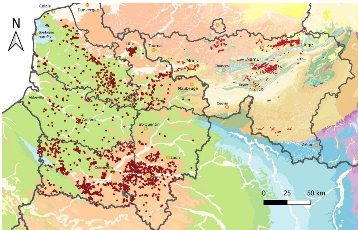
*Figure 9: Cartographie des carrières souterraines en Hauts-de-France et Wallonie sur fond de plan chronostratigraphique (sources: SPW, Géorisques et EGD).*
