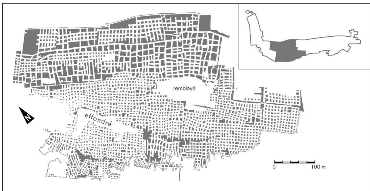
Figure 10: Exemple d'une exploitation de craie phosphatée par chambres et piliers aux carrières de la Malogne (Mons, Belgique; d'après les données du SPW). Le secteur détaillé représente une surface de 25 ha.
