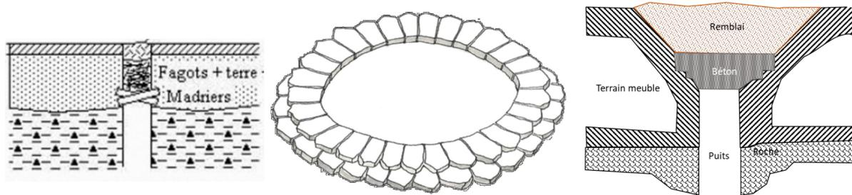
Figure 21: Exemples de bouchon rencontrés en carrières souterraines. A gauche, des poutres en bois (LCPC 2008). Au centre, une voûte en encorbellement faite de moellons ([www.parc-causses-du-quercy.fr](http://www.parc-causses-du-quercy.fr)). A droite, une dalle de béton (National Coal Board 1982 in Coal Authority!).
