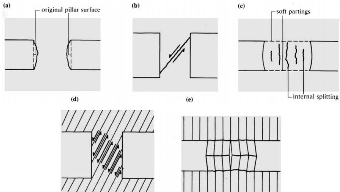
Figure 25: Modes de déformation des piliers. (a) Ecaillage. (b) Fracture en cisaillement. (c) Eclatement en présence de plans de stratification peu résistants au toit et au mur. (d) selon l'inclinaison des fractures par rapport à l'angle de frottement. (e) Flambage dans le cas d'une schistosité parallèle à la mise en charge (selon Brady & Brown 2005).
