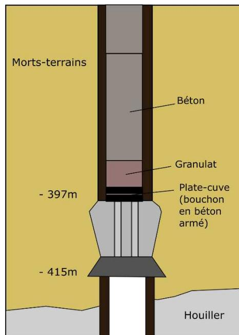
Figure 22: Exemple de plate-cuve de charbonnage, cas du puits Saint-Marguerite à Péronnes (BE). (Modifié d'après «Tunnels et ouvrages souterrains, n°180, 2003)
