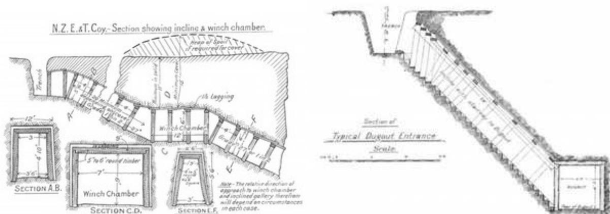
Figure 15: Schéma de départ d'une sape (à gauche) et d'un abri souterrain (à droite).
