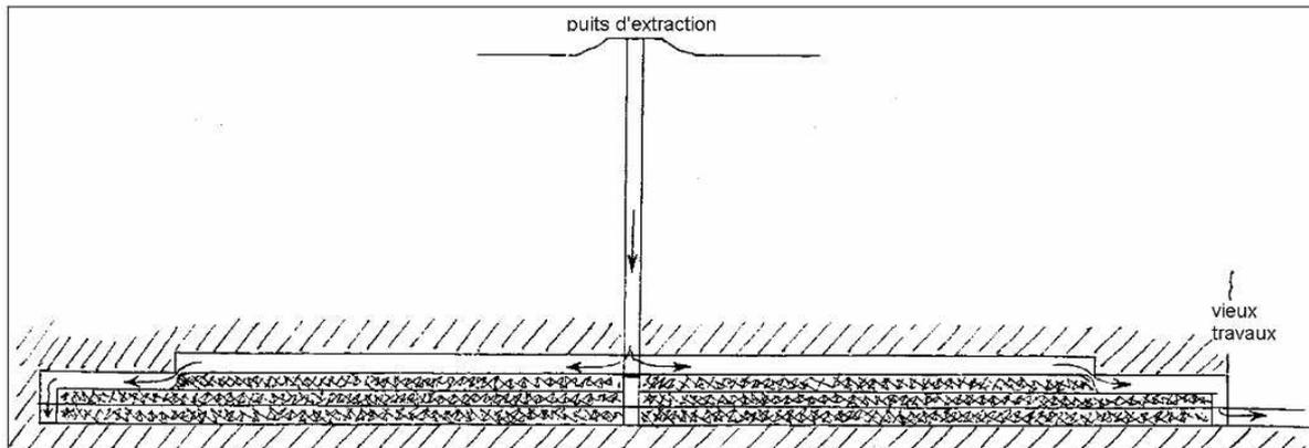
Figure 6: Coupe verticale type d'une exploitation de fer en Hauts-de-France par tranches montantes remblayées, extrait du rapport de Geoderis sur l'étude des aléas miniers dans le bassin ferrifère de l'Avesnois (Vuidart et al. 2009).
