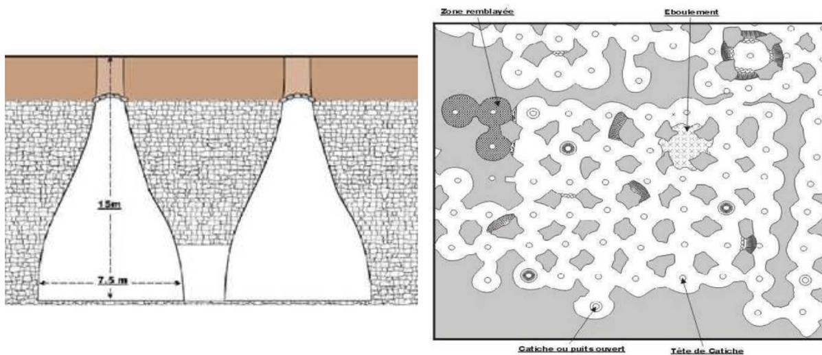
Figure 11 : Exemple d'une exploitation en catiche en région lilloise. A gauche, coupe verticale conceptuelle. A droite, vue en plan d'un réseau de catiches (Berrehouc G. et Lefebvre C. 2013).
