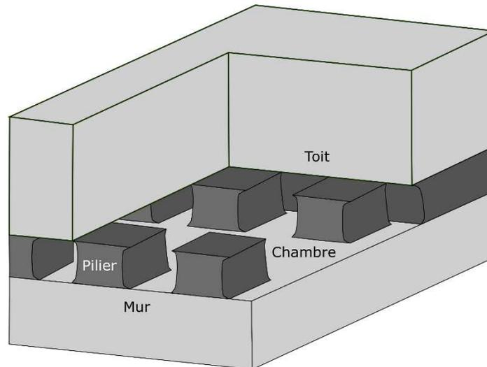
Figure 23: Configuration d'une exploitation en chambres et piliers.
