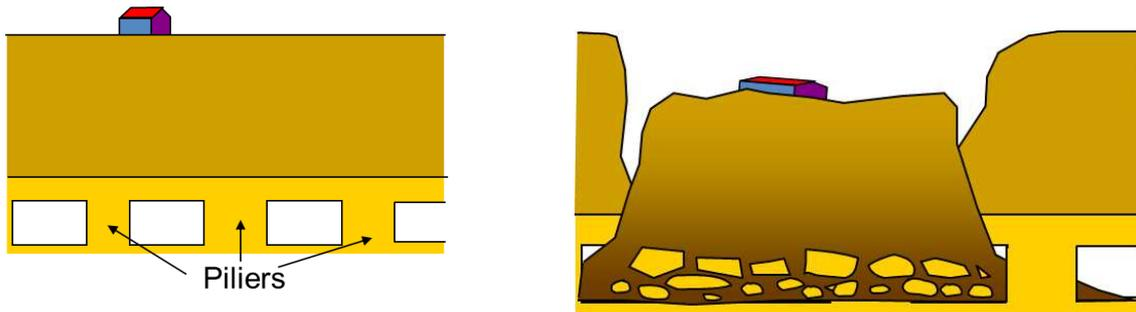
Figure 27: Mécanisme d'effondrement généralisé dans une exploitation en chambres et piliers (Dubois, 2019).
