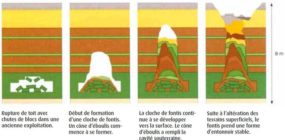
Figure 24: Mécanisme de formation d'un fontis (Didier et Watelet 2012).
