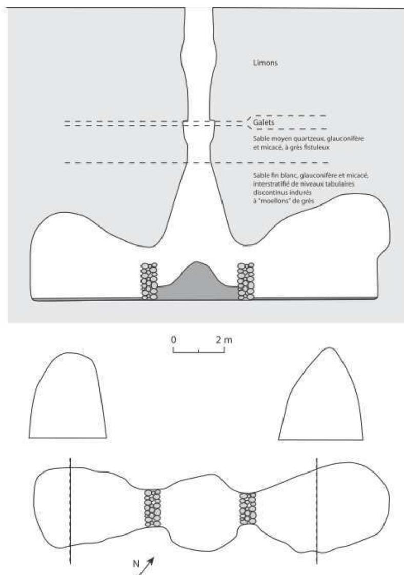
Figure 13: Coupe et plan d'une carrière souterraine de sables calcaires lutétiens à Waterloo (Funcken et Vrielynck, SPW).
