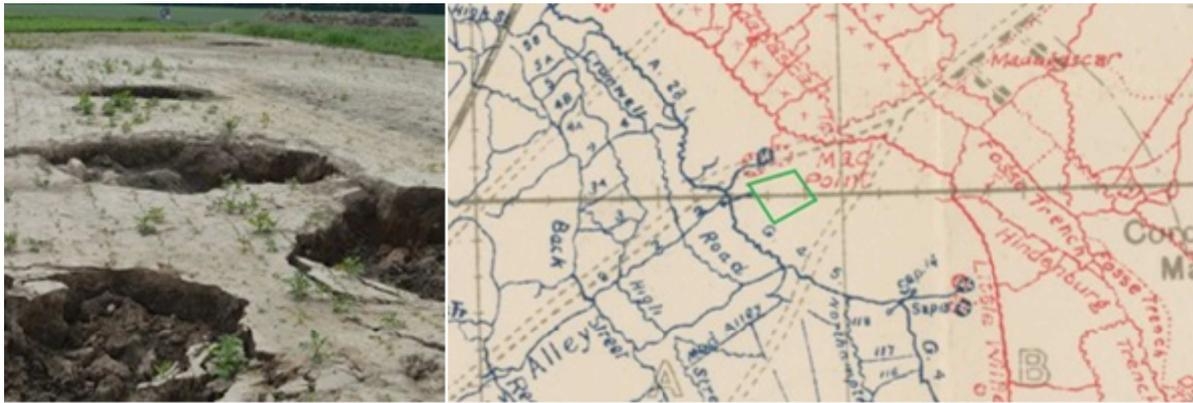
Figure 29 : A gauche, effondrements le long d'une sape à Auchy-les-Mines en 2016. A droite, carte du secteur du 04 mai 1917 précisant la zone des effondrements en vert.
