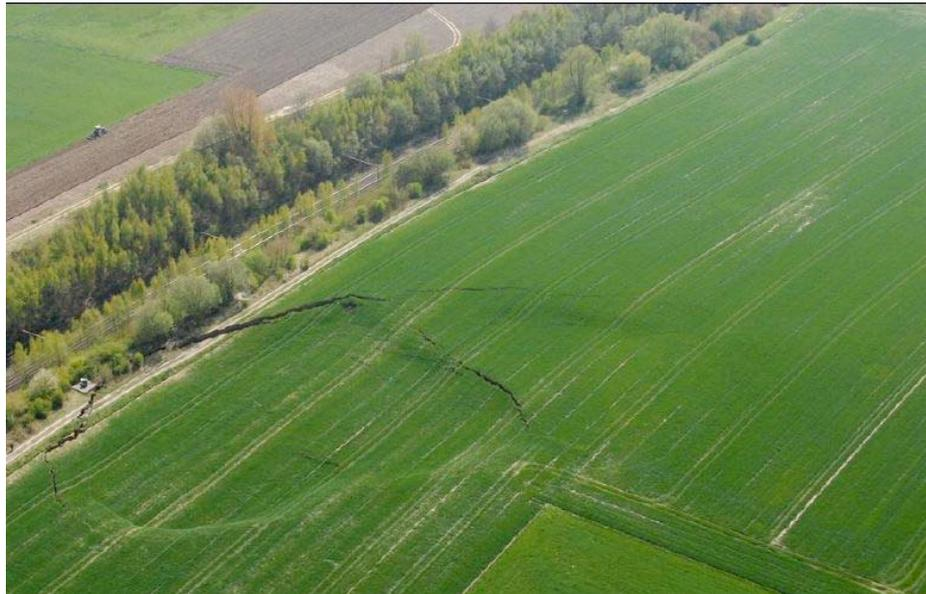
*Figure 8 : photographie aérienne d'un effondrement généralisé survenu aux carrières de la Malogne en 2015 (Thys, 2015 ; RISSC, 2020)*
