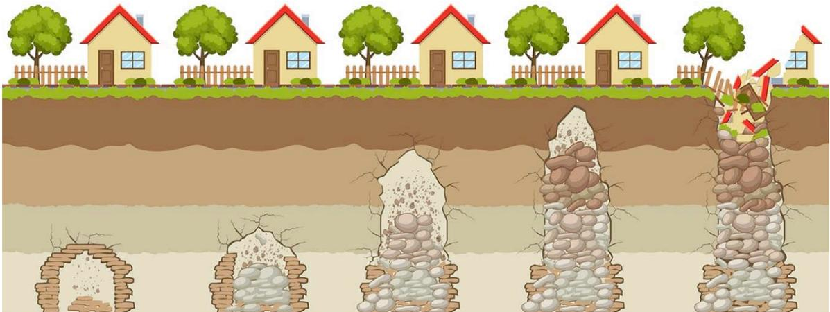
*Figure 7 : illustration de la formation d'un fontis, d'une chute de toit à sa manifestation en surface (source : <https://geoderis.fr/lapres-mine/thematiques/mouvements-de-terrain/>)*
