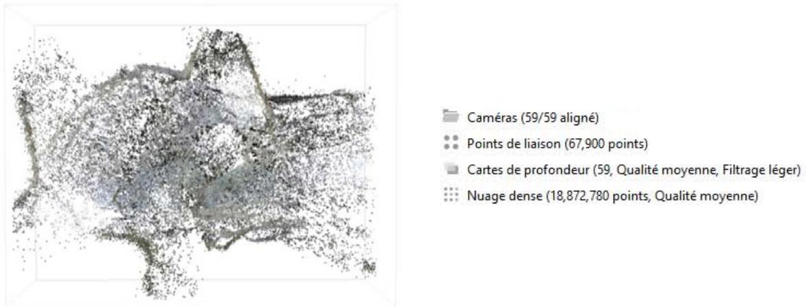
*Figure 35 : vue du dessus d'un nuage de point de galerie capturée au centre, et les données associées*
