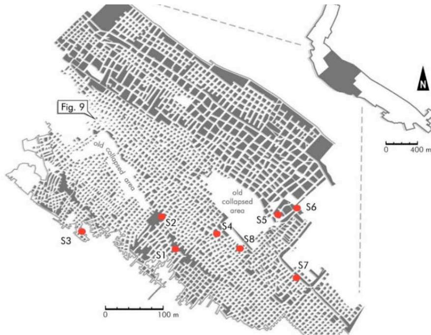
Figure 2 : plan des carrières de la Malogne illustrant la méthode d'exploitation par chambres et piliers (Georgieva et al., 2020)
