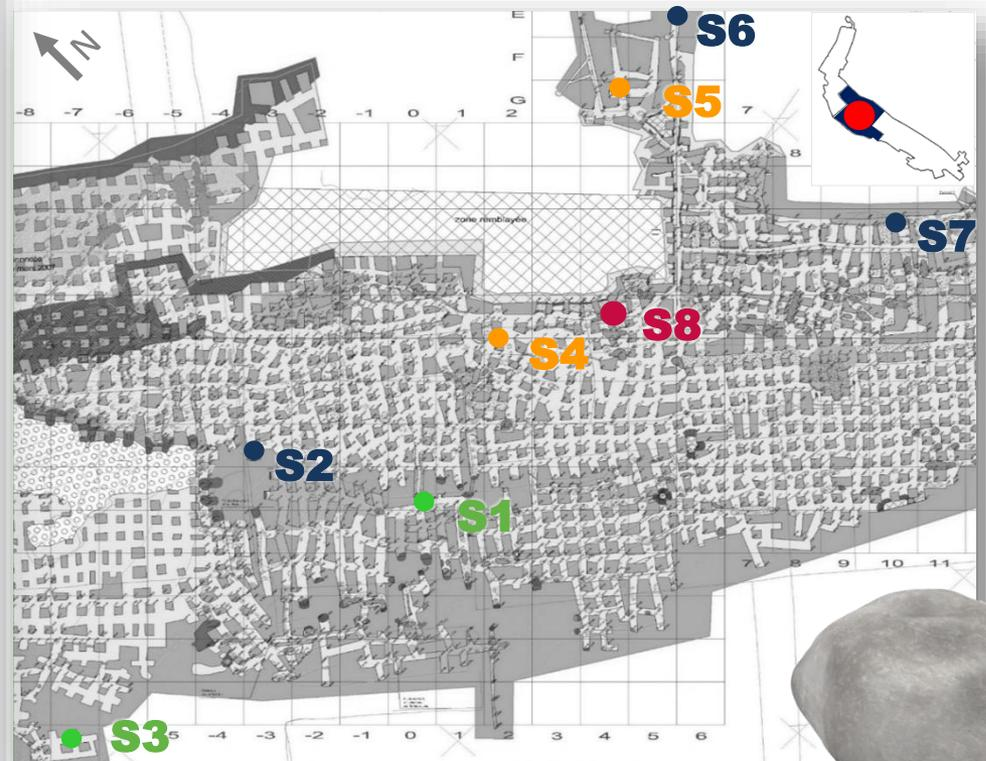
Plan de la carrière de la Malogne (chambres et piliers) avec la localisation des échantillons
